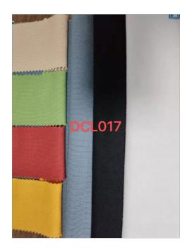
聚酯纤维的强度高、模量高、吸水性低,作为民用织物及工业用织物都有普遍的用途。作为纺织材料,涤纶短纤维可以纯纺,也特别适于与其他纤维混纺;既可与天然纤维如棉、麻、羊毛混纺,也可与其他化学短纤维如粘纤、醋酯纤维、聚丙烯腈纤维等短纤维混纺。其纯纺或混纺制成的仿棉、仿毛、仿麻织物一般具有聚酯纤维原有的优良特性,如织物的抗皱性和褶裥保持性、尺寸稳定性、耐磨性、洗可穿性等,而聚酯纤维原有的一些缺点,如纺织加工中的静电现象和染色困难、吸汗性与透气性差、遇火星易熔成空洞等缺点,可随亲水性纤维的混入在一定程度上得以减轻和改善。涤纶加捻长丝(DT)主要用于织造各种仿丝绸织物,也可与天然纤维或化学短纤维纱交织,还可与蚕丝或其他化纤长丝交织,这种交织物保持了涤纶的一系列优点。长沙练功服面料多少钱一公斤正确分析识别面料性能并准确合理地运用于服装设计是每一个设计师需要掌握的基本知识。
